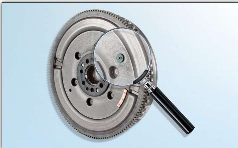
Foto 1: Zabezpieczenie transportowe pozostaje w dwumasowym kole zamachowym
